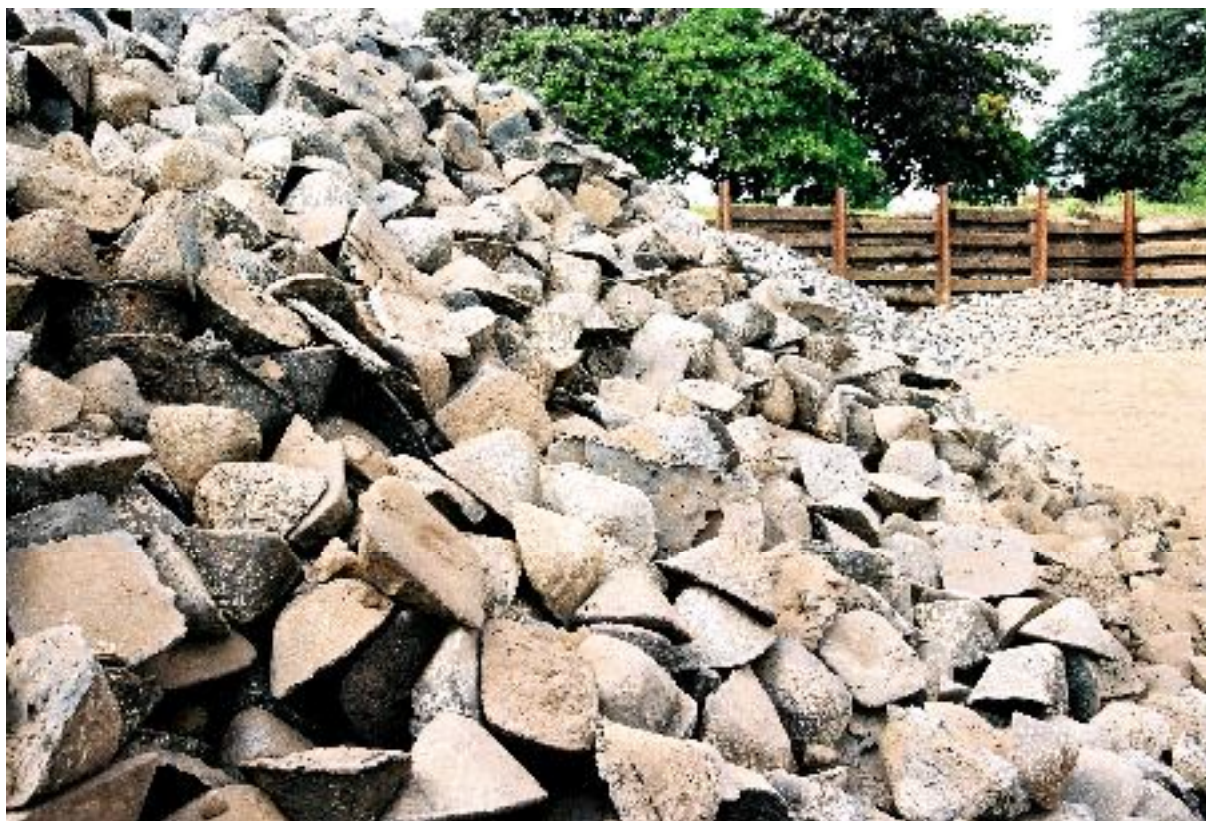
Photo numéro 37 : Les lingots de gueuse
