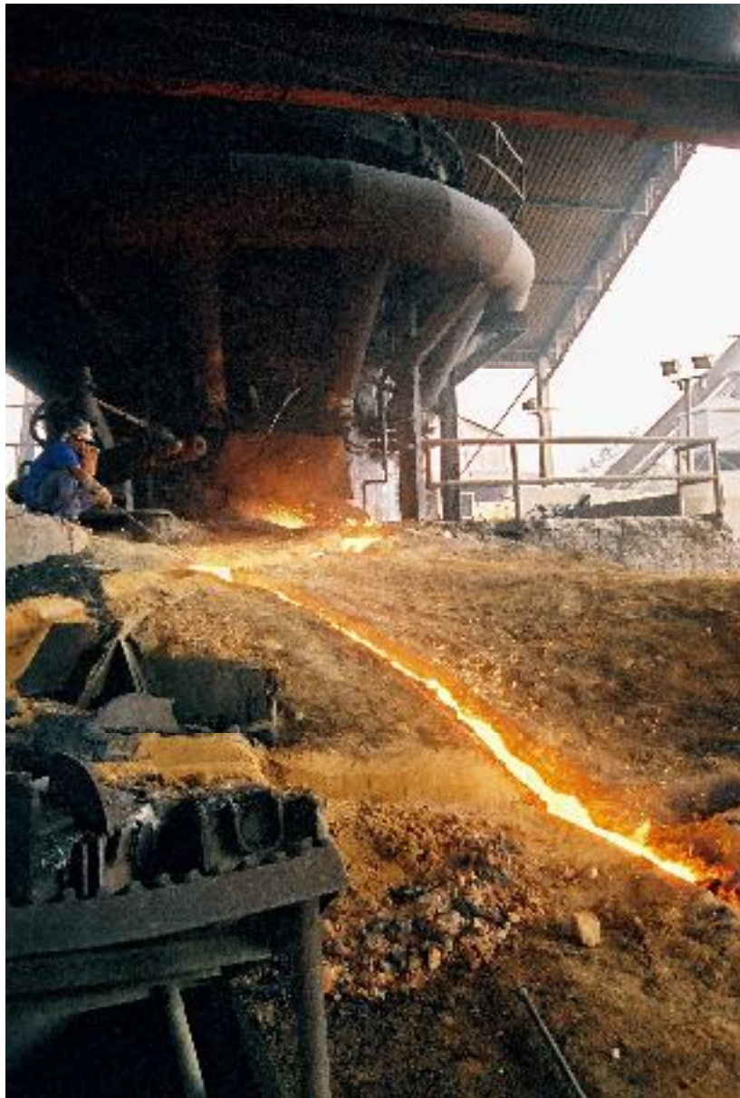
Photo numéro 35 : Les canaux à même la terre.
