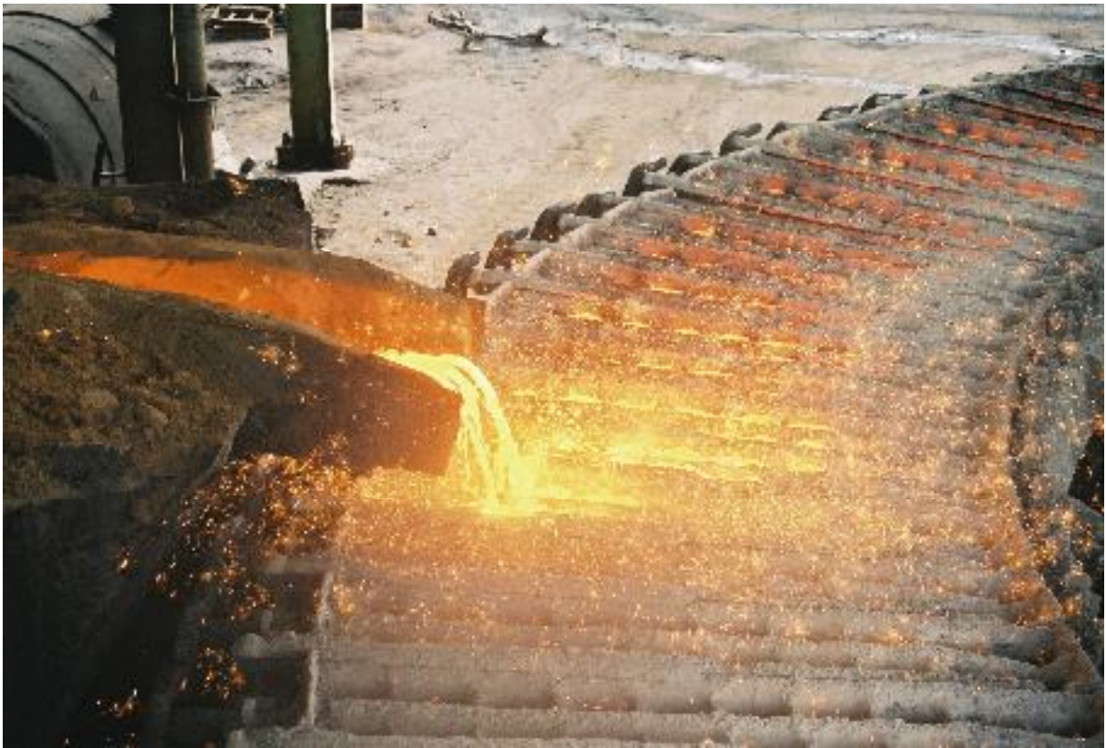
Photo numéro 36 : Le remplissage des godets
