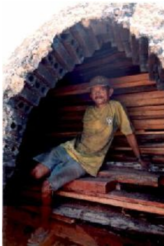
Photo numéro 16 : Le remplissage du four
