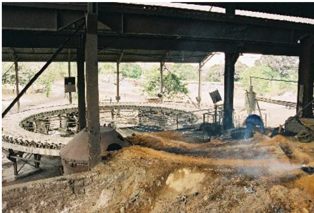
Photo numéro 34 : La séparation de l'escória et de la gueuse
