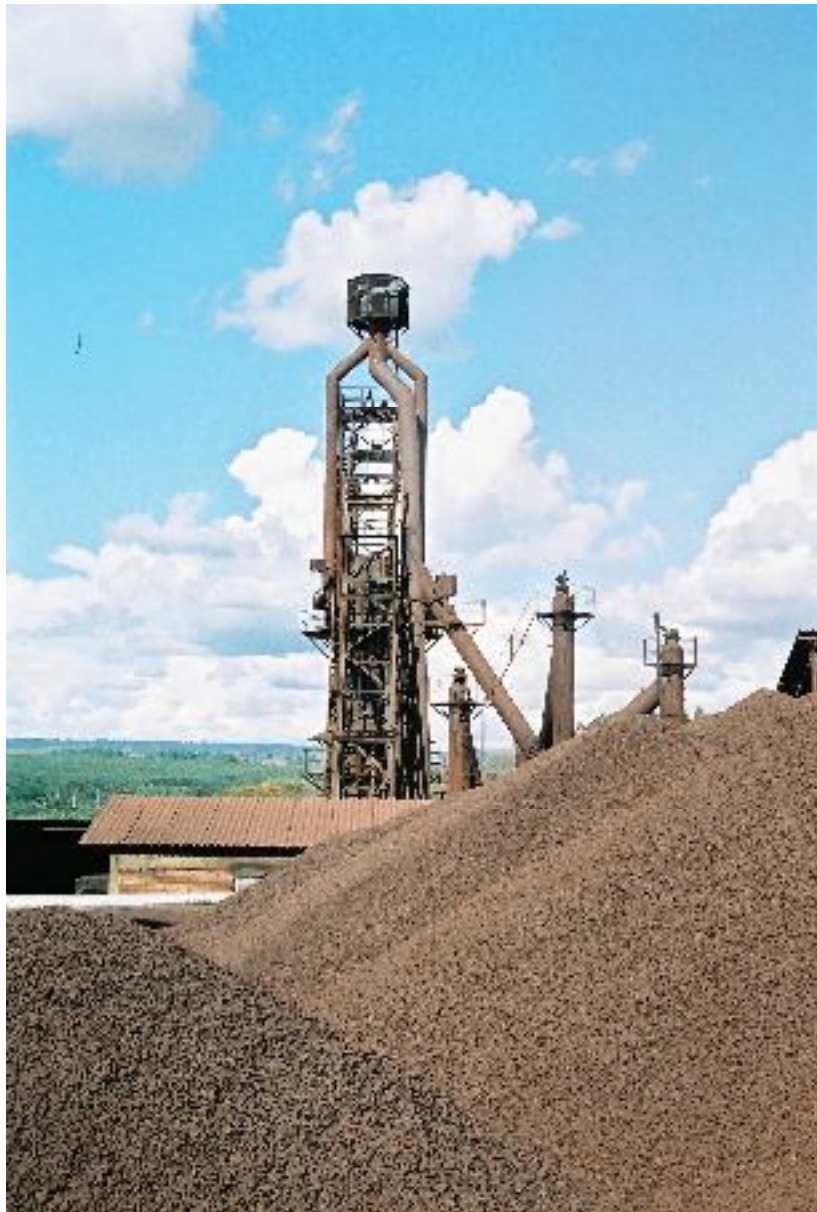
Photo numéro 31 : Stockage du minerai devant un haut fourneau.
