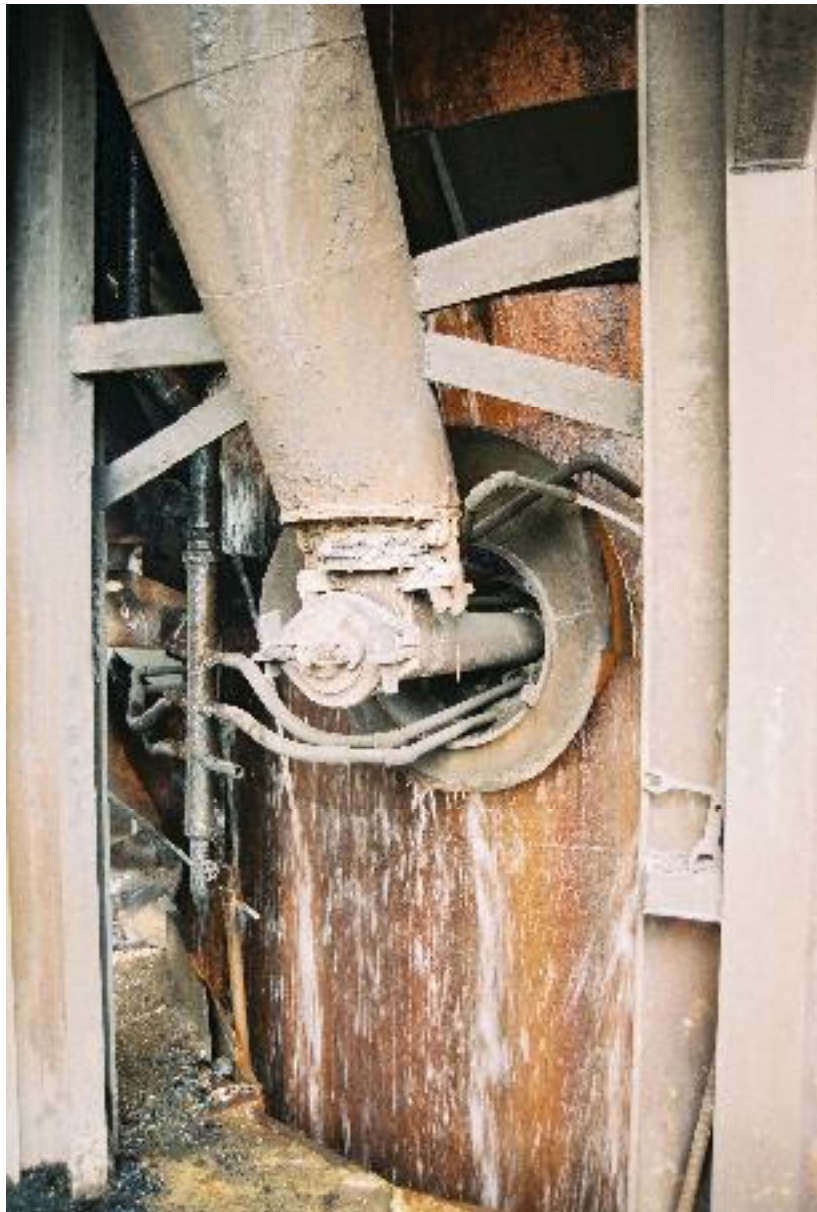
Photo numéro 33 : Injection des gaz dans le four
