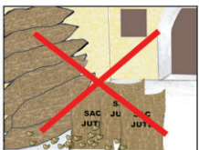
Mauvais stockage (sacs déposés à même le sol, magasin non aéré)
