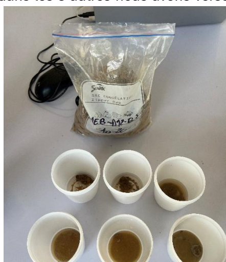
Figure 5 : Photo d'un test de stabilité structurale
