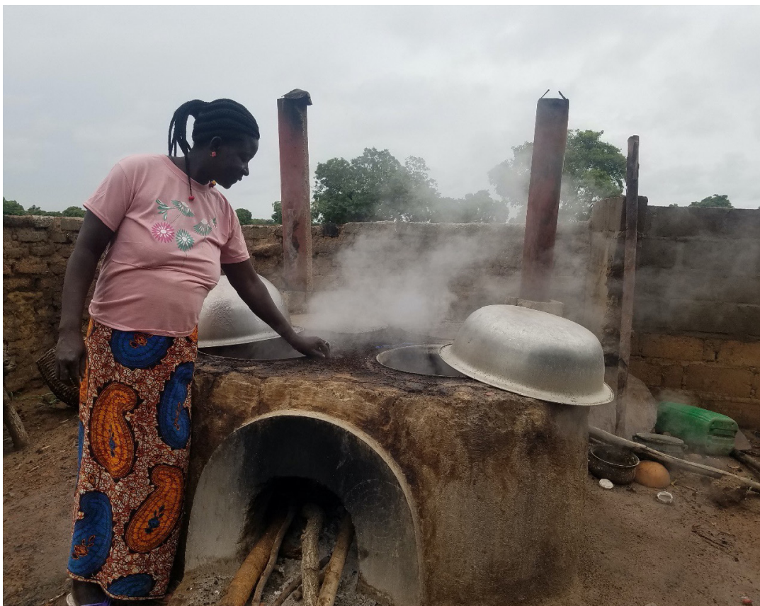
©nitidae Juin 21 : Foyer amélioré à faible consommation énergétique pour la préparation du dolo
