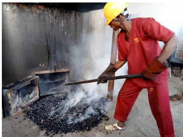
Figura 43. Descarregamento do carvão do forno. Projecto Agrovalor RCI (Nitidæ, 2017-2021).
