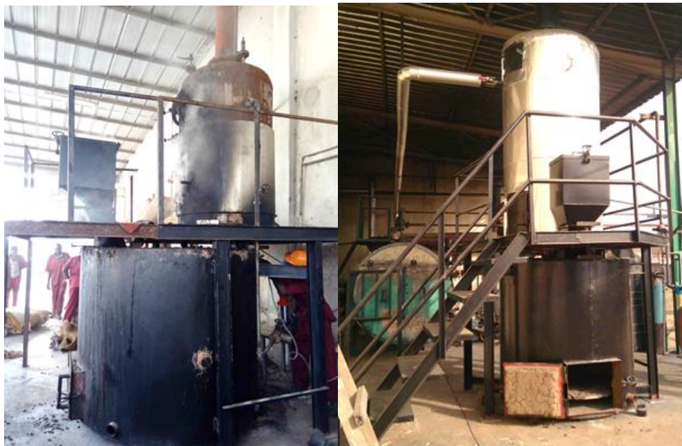
Figura 40. Dois fornos de pirólise em fábricas oeste-africanas, com as caldeiras acima.
