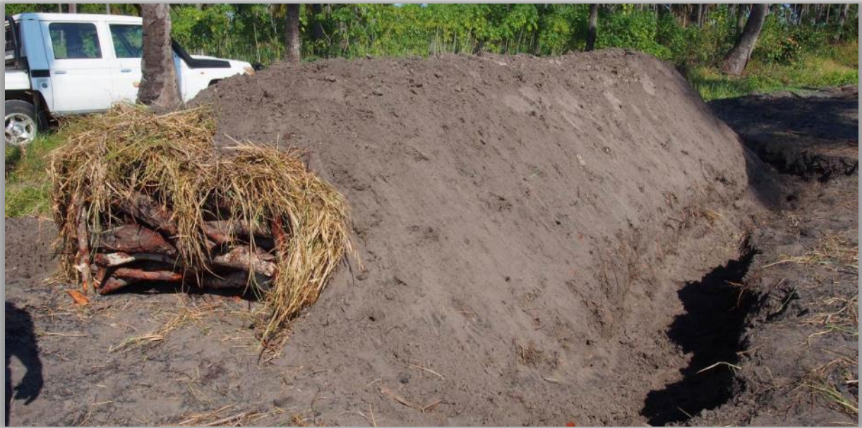
Photo 5 - Four en "meule" dont la carbonisation n'a pas encore débuté (Mangrove de Pebane). Dimensions : environ 80 cm de haut, 1 m de large et 8 m de long
