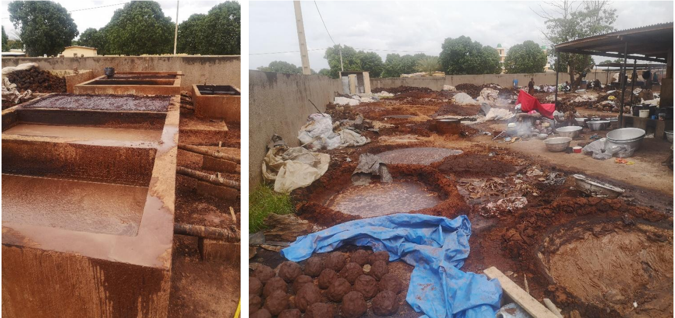
Figure 6 : Bacs de décantation et décantation dans des fosses dans le sol avec récupération et séchage des tourteaux.
