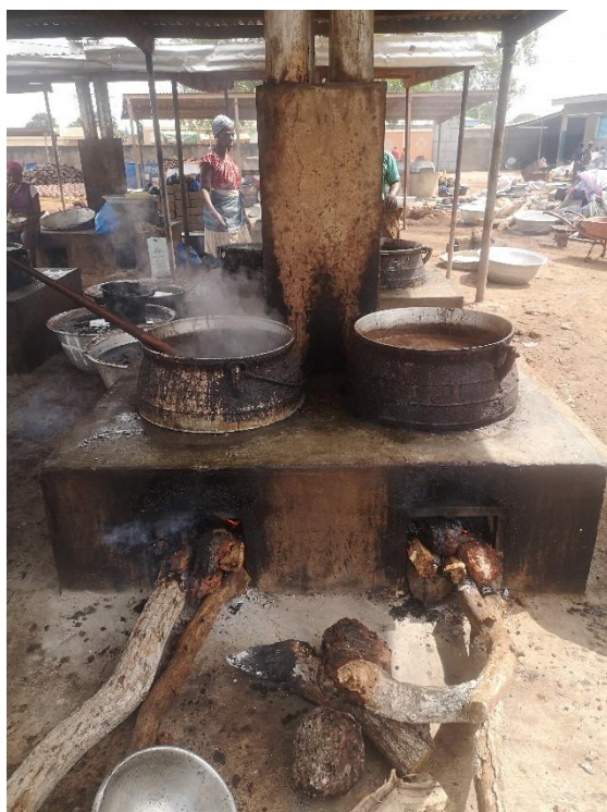
Figure 4 : Foyers améliorés double marmite et foyers 3 pierres.
