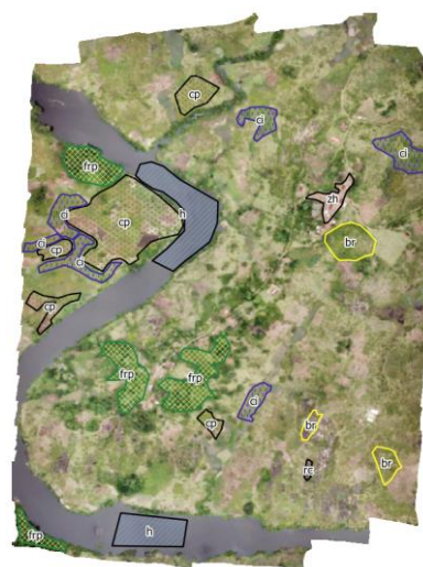
Figure 6 : Indentification des parcelles d'entrainement sur les mosaïques d'images drone de 10 cm de résolution
