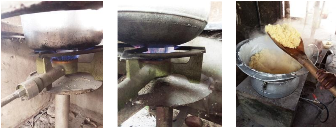
Figure 3 : Illustration de l'utilisation du biogaz produit au niveau des digesteurs
