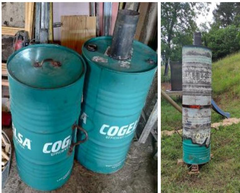
Figure 2 : Exemple de four en fût métallique. (Source : Yann Gressier, 2023)
