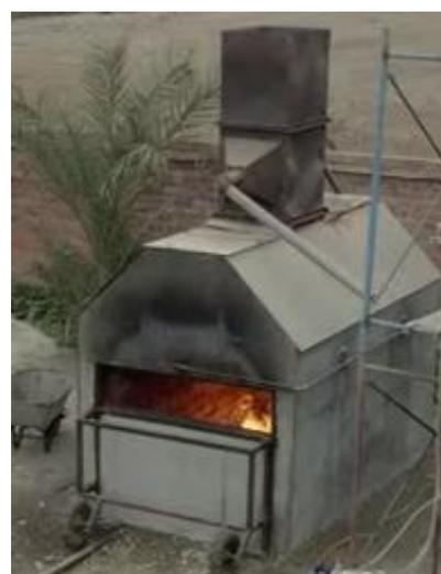
Figure 4 : Image d'un four à rideau de flamme (Source : Cornelissen et al., 2016)
