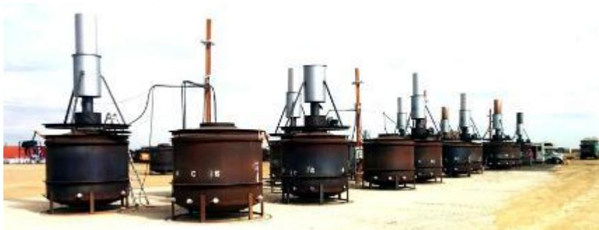
*Figure 6 : Modèle de fours à pyrolyse sur le site de Biochar Now*
