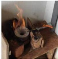
Pour le moment, le biogaz produit par le traitement des boues de latrines est valorisé sur le site (cuisson via l'utilisation d'un réchaud à biogaz à large diamètre et éclairage via 3 lampes à biogaz).
