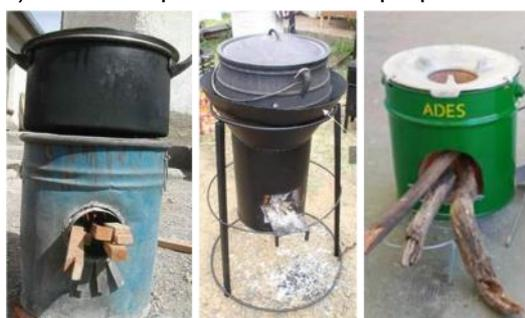
de combustion permet une meilleure circulation de l'air (oxygène) afin d'optimiser la combustion. La cheminée de la chambre de combustion permet la combustion des fumées par la flamme. L'isolation de la chambre de combustion maximise l'acheminement de la chaleur vers la marmite.
