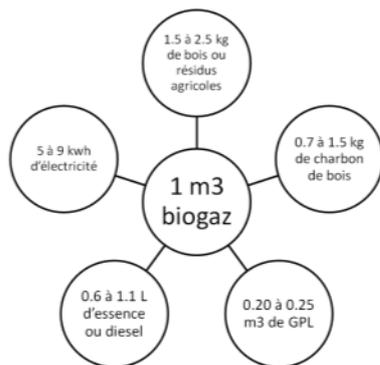
**Figure 12 - Equivalent énergétique d'un m3 de biogaz**
