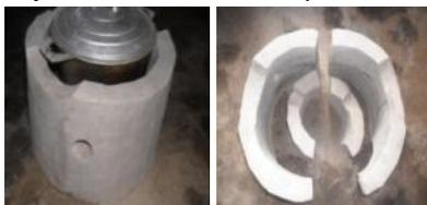
Le modèle « kopa-droa » bipied permet d'utiliser des combustibles de substitution comme le charbon à base de savane. Ce modèle est breveté par le CNRIT et diffusé par le biais de projets avec des associations environnementales comme l'ANAE. Les formateurs et techniciens des associations partenaires sont formés à leur fabrication. La construction de ces
