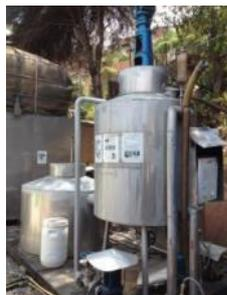
de pré-digestion de 5 m<sup>3</sup> en PEHD. Ce mélange est ensuite pasteurisé (au-dessus de 70°C) dans une cuve en inox de 5 m<sup>3</sup> puis refroidi dans une cuve de refroidissement en inox.
