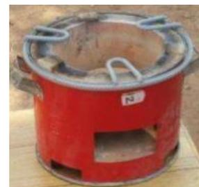
Les tests de performance (TEE réalisés en laboratoire et TCC dans des conditions réelles auprès de 100 ménages) ont mis en évidence des réductions d'utilisation de bois-énergie allant jusqu'à 27 % pour le charbon et 66 % pour le bois. Enfin, ces tests ont permis de mesurer une réduction des émissions de GES de 3,3 tCO<sub>2</sub> et 3,6 tCO<sub>2</sub> par an respectivement par rapport au foyer traditionnel Toko Telo ou Fatapera. Enfin, la durée de vie de ces deux foyers est estimée à 5 ans.
