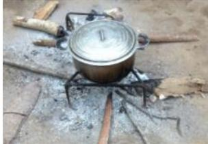
A Madagascar, le foyer le plus utilisé est le foyer Toko Telo qui s'apparente au foyer 3 pierres. Il s'agit d'un trépied simple en fer rond soudé ou relié avec des fils de fer. Il peut être facilement transporté, est abordable et fabriqué localement. Il est adapté à une gamme relativement large de marmites. Sa durée de vie est relativement longue
