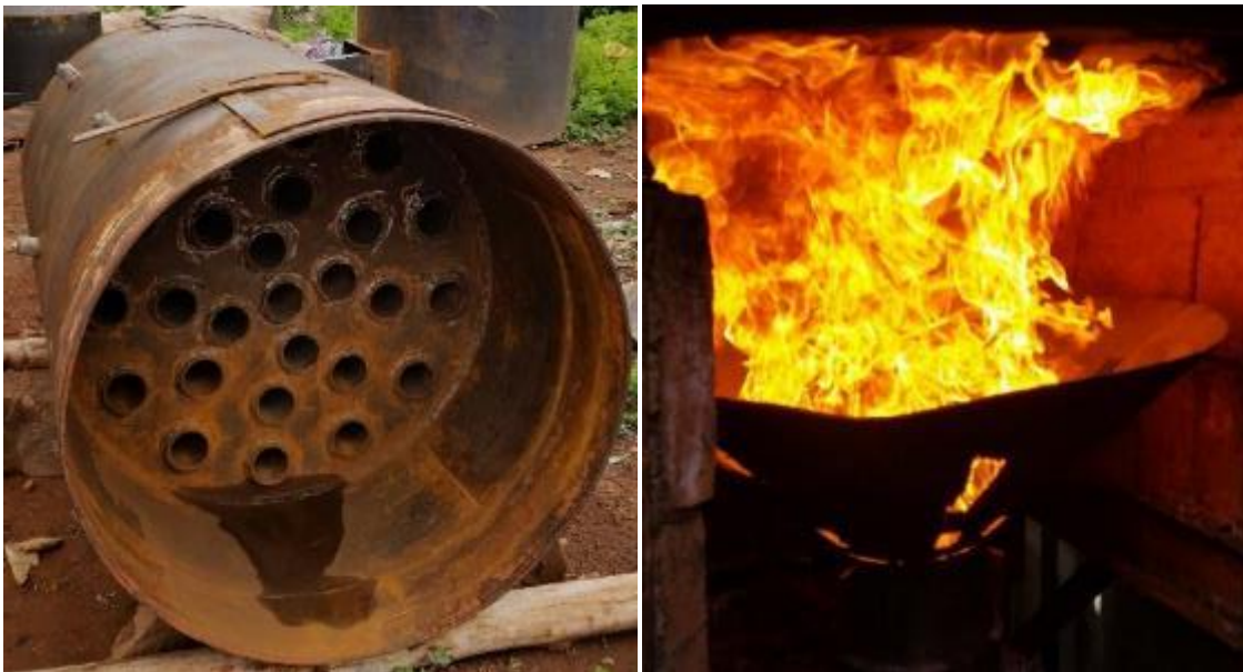
Figure 5 : Chaudière en construction à Bobo et flamme d'un four d'une usine de séchage de mangues de Bobo.
