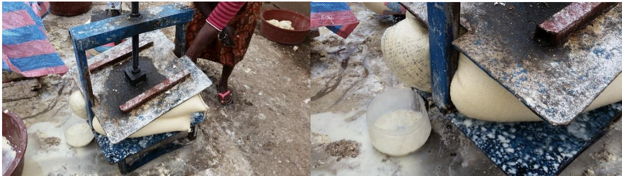
Figure 16 : Collecte des eaux de pressage.
