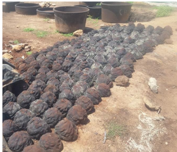
Figure 7 : Fosses à décantation dans le groupement Chigata, à Korhogo et séchage des boules de tourteau.
