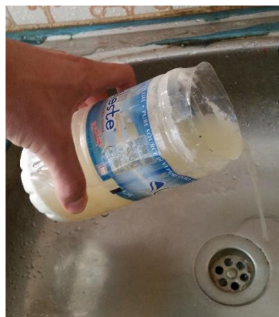
Figure 19 : Évacuation du surnageant liquide.
