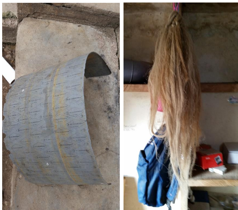
Figure 2 : Joint de type « culasse » (gauche) et « filasse » (droite).
