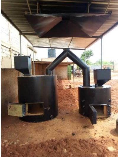
Figure 16. Installation expérimentale de carbonisation en parallèle réalisée par Nitidæ à Bobo-Dioulasso.
