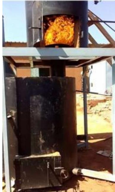
Ce principe de combustion pour la coque d'anacarde est relativement récent mais tend à se développer de plus en plus du fait de sa propreté. Malheureusement celui-ci ne fonctionne pour l'instant que pour des chaudières verticales et donc assez petites, consommant de l'ordre de 1000 à 1500 kg/j de coques et non pour les chaudières horizontales de plus grandes capacités ce qui empêche les grands consommateurs et potentiels gros clients d'y avoir accès.
