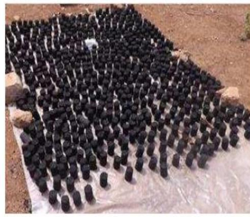
Figure 13. Briquettes de charbon de coque
