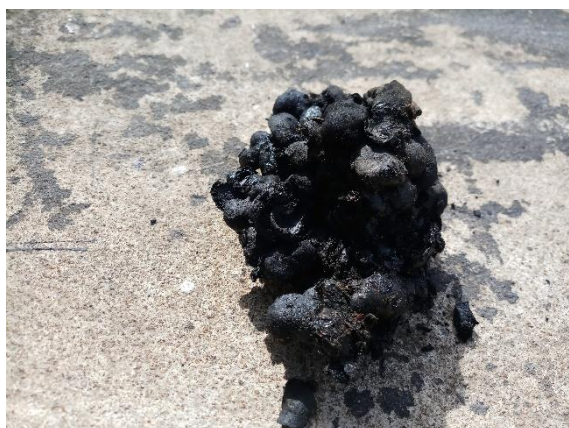
Figure 7 : Charbon de coque d'anacarde produit par le four H2CP de SOBERY
