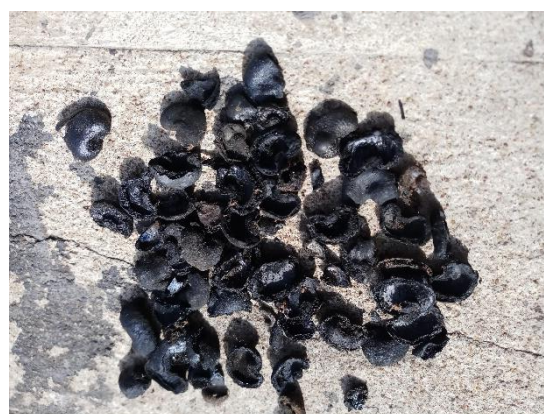
Figure 7 : Charbon de coque d'anacarde produit par le four H2CP de SOBERY
