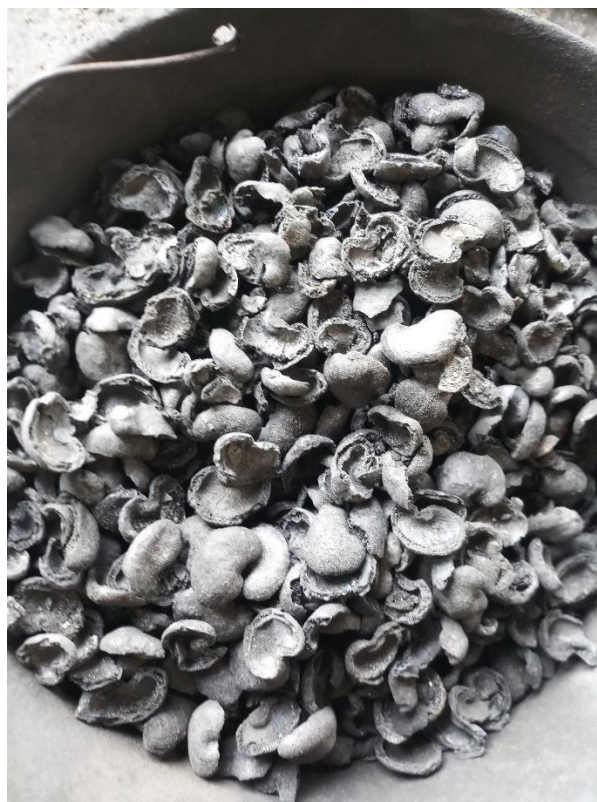
Figure 2 : Charbon de coque d'anacarde produit par le four H2CP de CASA
