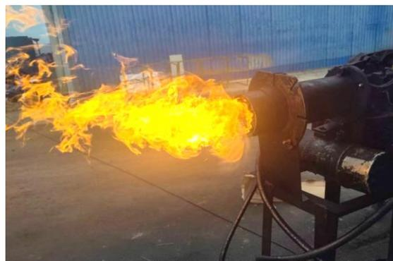
Todo o equipamento de combustão (caldeira, forno, torrefação, etc.) pode ser facilmente adaptado ao uso de CNSL, bastando para isso selecionar um queimador adequado. As gamas de queimadores são adaptadas a cada necessidade de aquecimento. Existem queimadores adaptados ao CNSL, que incluem um pré-aquecedor para baixar a viscosidade. A gama de potência é também muito grande: 100 kW a 10.000 kW, correspondendo a 10-1.000 L/hora de consumo de combustível.
