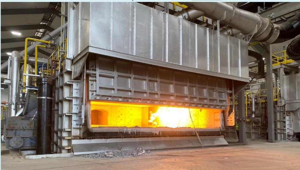
**Figura 8.** Forno de fundição de alumínio alimentado com combustível líquido
