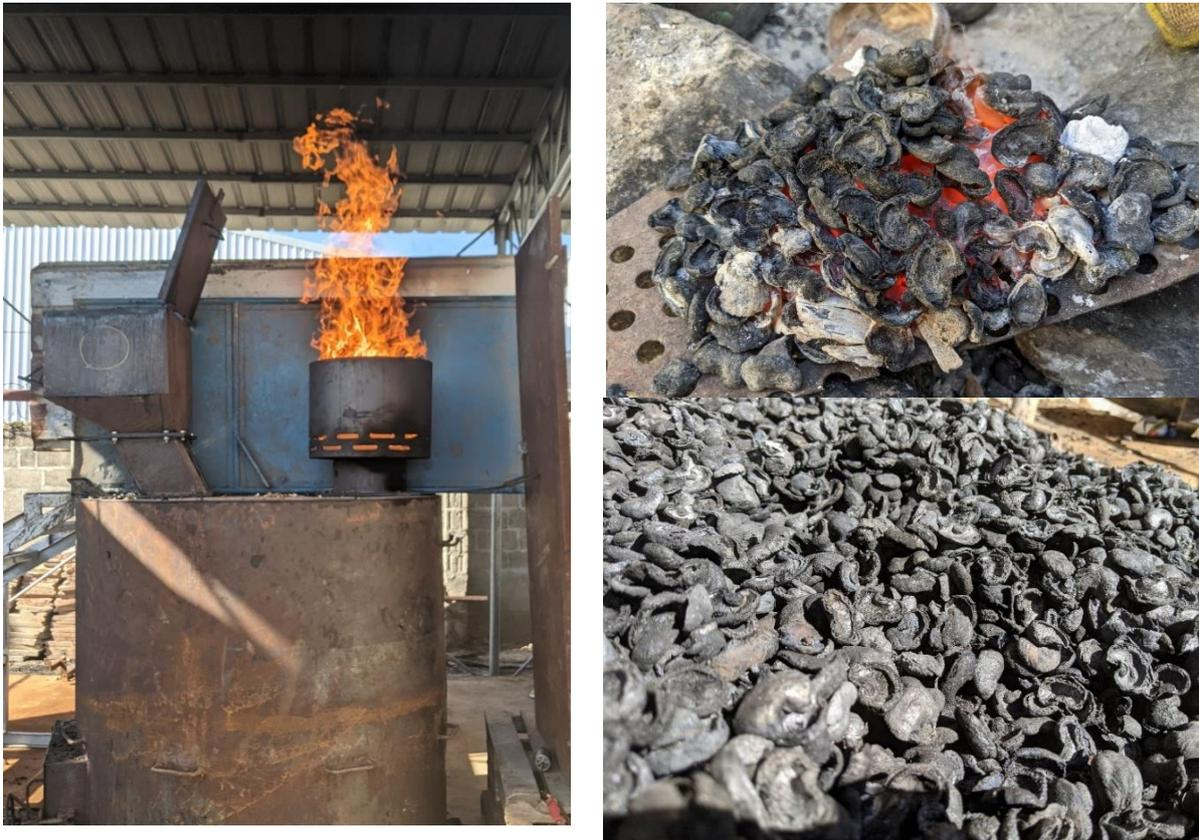
*Figura 25. O gás de pirólise inflamável é produzido no queimador do H2CP. No final da operação, obtém-se carvão vegetal*
