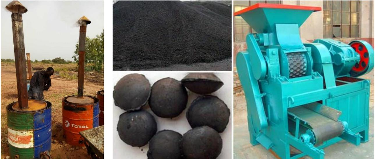
**Figura 32.** Um forno de barril é utilizado para a carbonização de cascas de coco (esquerda). O carvão vegetal moído é depois compactado numa máquina de briquetagem (direita).
