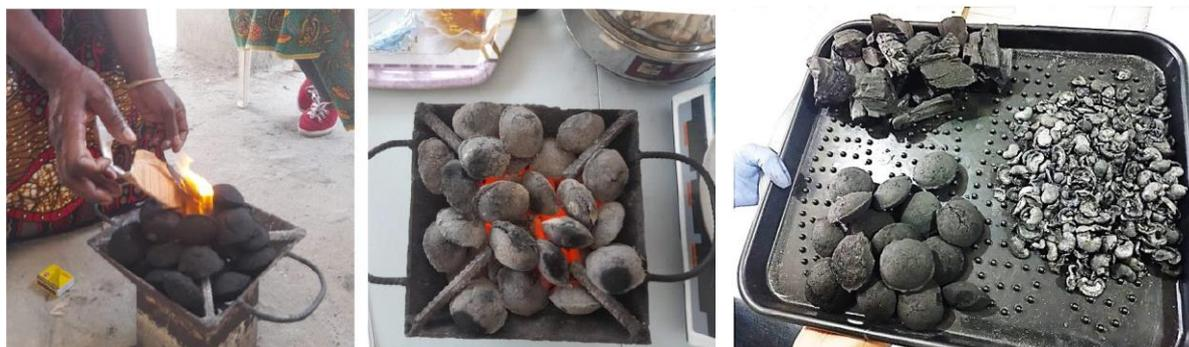
Figura 28. Ensaios de cozedura com briquetes de casca de caju (esquerda e meio); os três materiais ensaiados pelo laboratório do BECT para testes comparativos de desempenho de combustão e emissões (direita).
