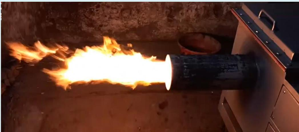
**Figura 15.** Queimador de biomassa sólida adaptado à torta de casca de caju para uma combustão adequada em pequena escala.
