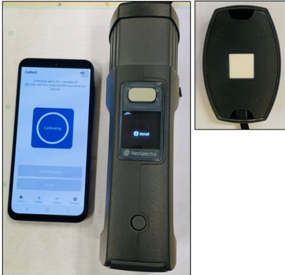
Figure 14. Messages affichés sur l'application et sur l'écran du spectromètre indiquant la fin de la calibration, et « blanc » de calibration dans le couvercle.
