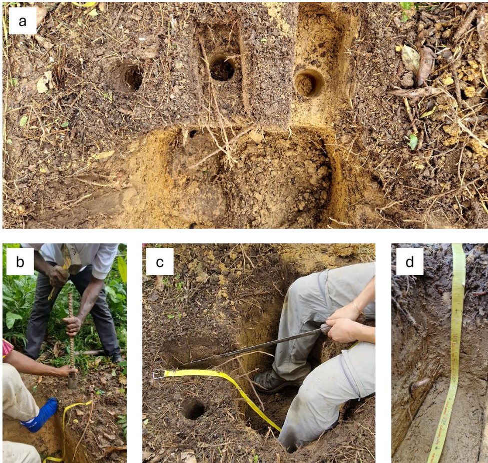
Figure 4. a) Vue zénithale de la zone de prélèvement montrant les emplacements des échantillons prélevés à 0–10 cm (gauche), 10–20 cm (centre) et 20–30 cm (droite) ; b) placement vertical de l'échantillonneur de sol en cylindre à proximité du profil ; c) découpe de la tranchée à l'aide d'un couteau et d'un mètre ruban ; d) positionnement du mètre ruban pour localiser la profondeur de 20 cm avant le prélèvement de l'échantillon de 20 à 30 cm.
