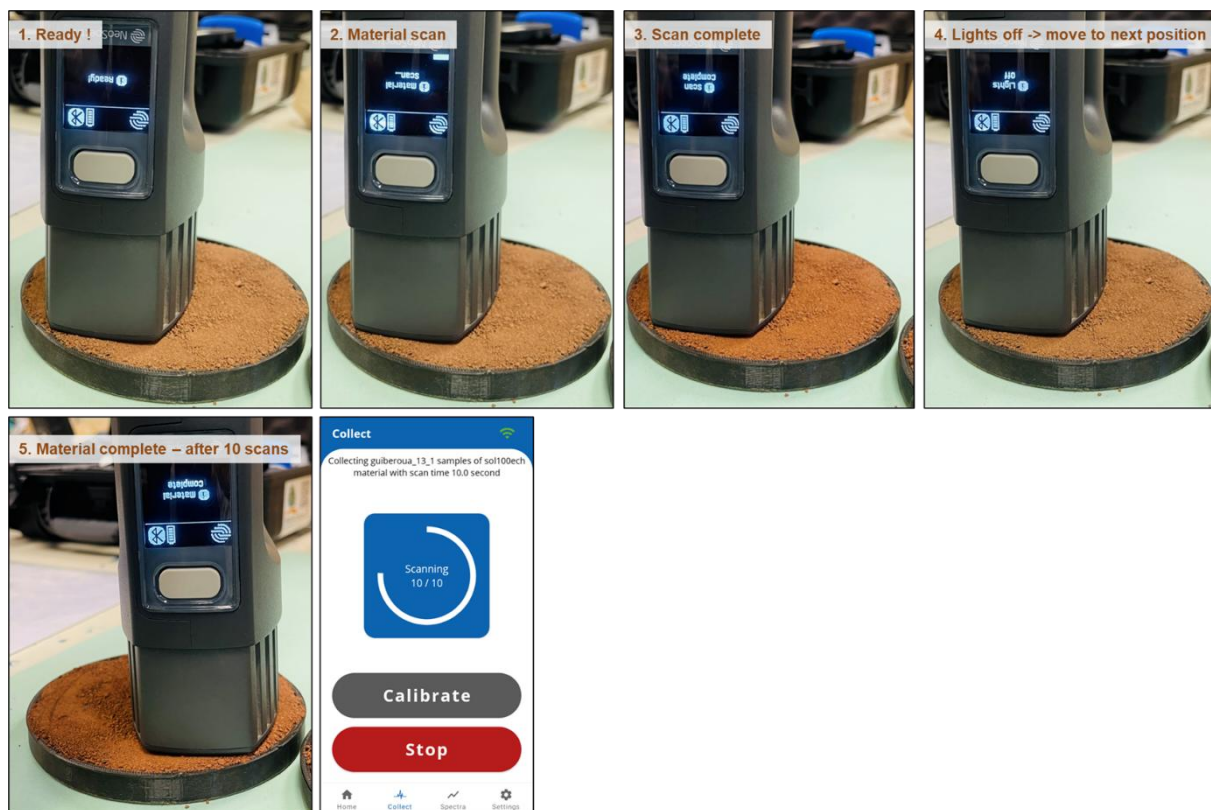
Figure 16. Succession de messages affichés sur l'écran du spectromètre au cours d'une séquence de mesure. L'application NeoSpectra Collect affiche en parallèle un indicateur de progression permettant de suivre l'avancement de la série de scans.
