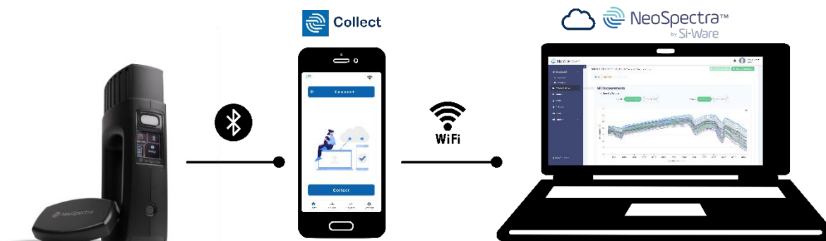
Figure 7. Schéma de la connexion entre le spectromètre et l'application NeoSpectra Collect via connexion Bluetooth et avec le portail cloud Neospectra via connexion Wi-Fi.
