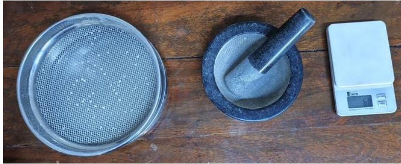
Figure 5. Le tamis et le récipient de collecte, le mortier et pilon et la balance utilisés pour la préparation des échantillons.
