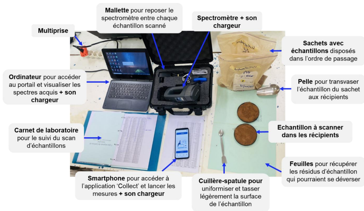
Figure 10. Suggestion d'organisation des éléments nécessaires pour les acquisitions des données spectrales sur la paillasse.
