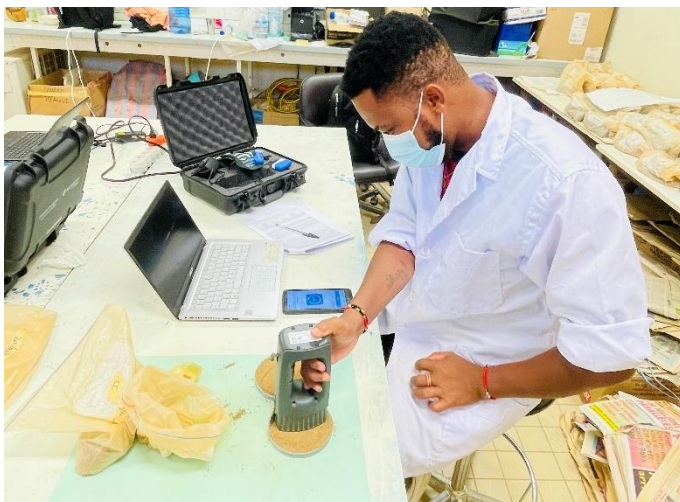
Figure 15. Placement de l'opérateur pendant l'acquisition de données spectrales en position assise face aux écrans de l'application NeoSpectra Collect et du spectromètre.
