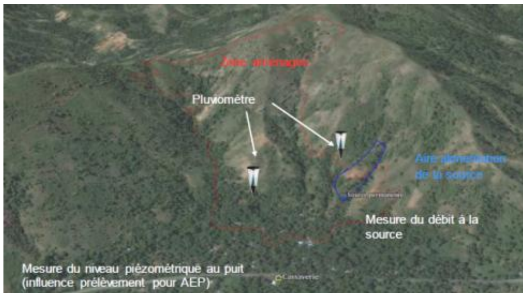
Figure 19 : Dispositif de mesure du bilan hydrologique de la source Peltan.
