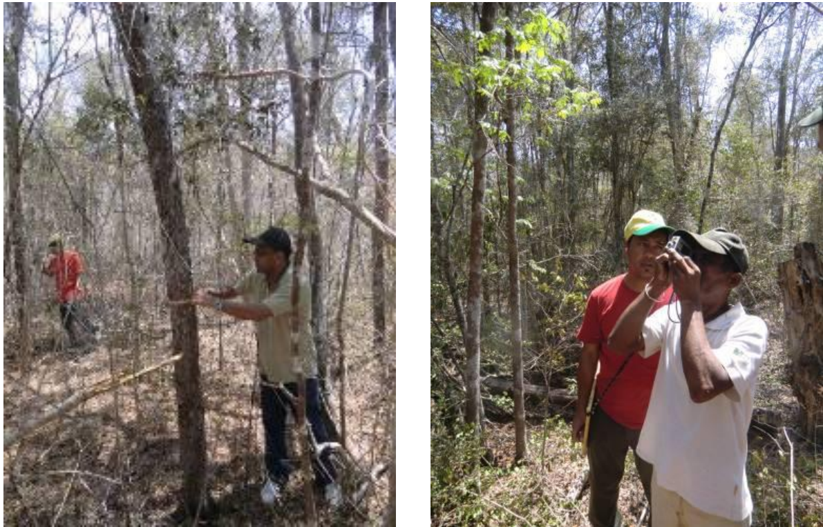
Figure 13 : Mesure du diamètre des arbres à hauteur de poitrine (gauche), mesure de la hauteur des arbres avec un dendromètre (droite).
