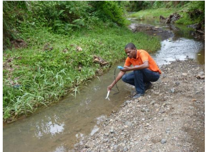
Figure 17 : Mesure du débit par la méthode de traçage
