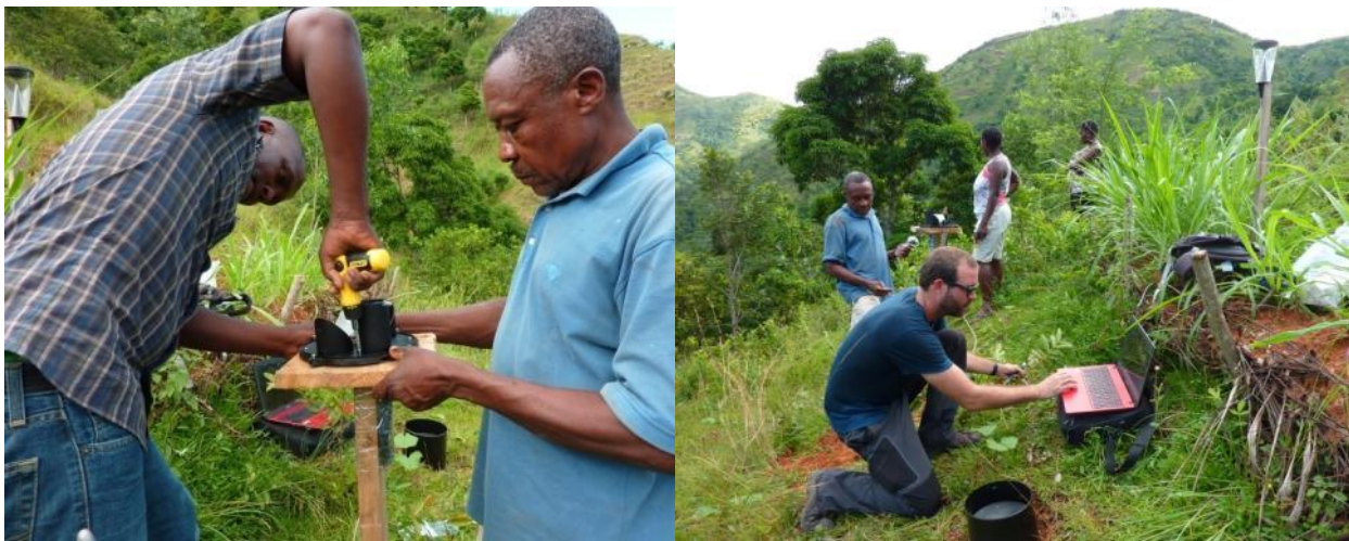
Figure 16: Installation du pluviomètre automatique (gauche) et relevé des données régulièrement (droite)
