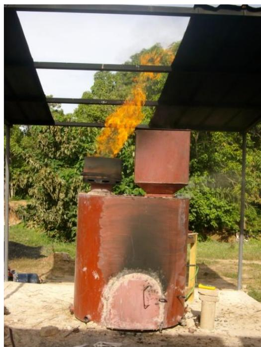
Une partie des coques est brûlée dans le four, l'autre partie subit une décomposition thermique qui les transforme en charbon. Les fumées libérées par la carbonisation sont brûlées à la sortie du four dans un foyer de post-combustion. **Les fumées indésirables sont ainsi éliminées** et la flamme de post-combustion produit une **quantité importante d'énergie**.
