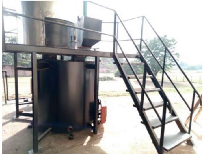
Image 1: four à pyrolyse
