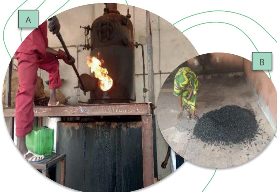
Image 2: (A) mise à feu du gaz de pyrolyse; (B) charbon de coques issu du four à pyrolyse
