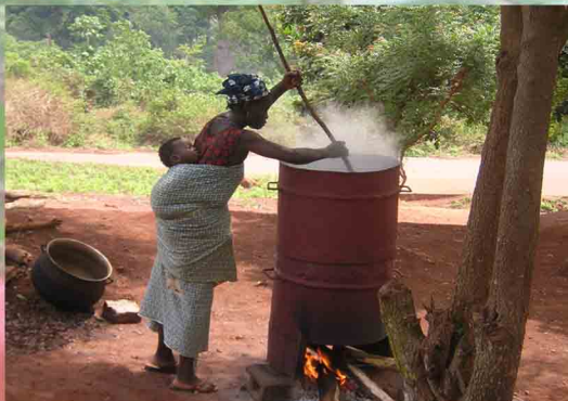
Fragilisation des coques : Les noix brutes sont triées puis passées à la vapeur dans une bouilleuse ...
